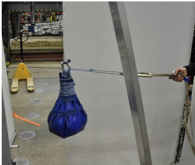
Kuva 3.2 Iskukappaleen vaijerin mitta l riippui iskukorkeudesta. Iskukappale koottiin lyijykuulupunnuksista, jotka asetettiin suojapeitteestä leikatun kappaleen sisään. Iskukappale roikutettiin teräsvaijerilla ja vedettiin köyden avulla halutulle korkeudelle.
