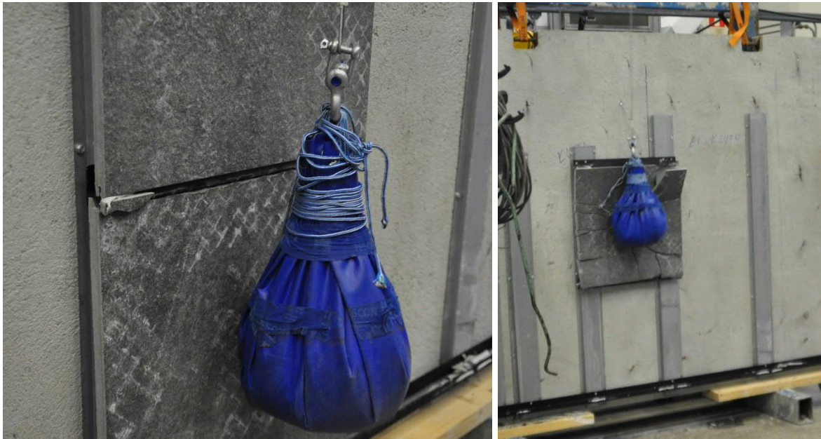
Kuva 4.1 Levyn B iskukohdan 2 (vas.) ja 2 ekstra (oik.) murtotavat.
