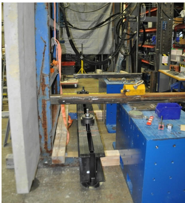
Kuva 3.1 Testattavat järjestelmät kiinnitettiin betoniseinäelementtiin, joka tuettiin teräskehikon avulla voimalattiaan.
