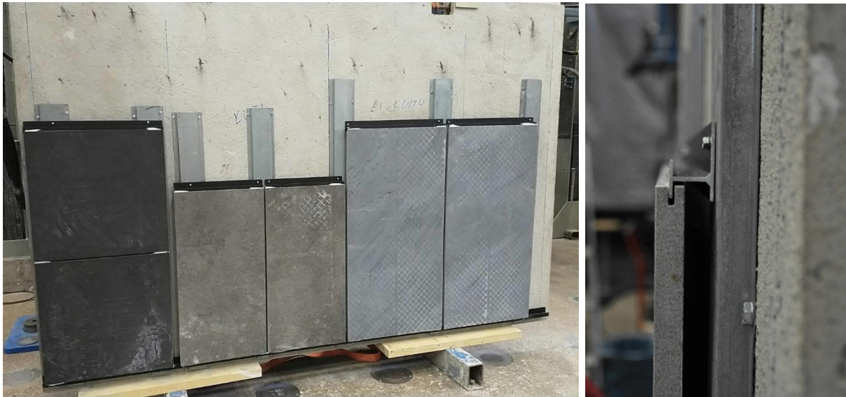
Kuva 2.2 Koeseinä levyt asennettuna. Levyjen kiinnitys vaakarankaan tapahtui levyn ylä- ja alareunan urasta.
