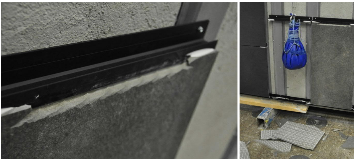
Kuva 4.2 Levyn C iskukohtien 1 (vas.) ja 2 (oik.) murtotavat.
