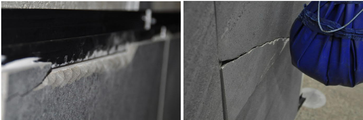
Kuva 4.3 Levyn D iskukohtien 1 (vas.) ja 2 (oik.) murtotavat.
